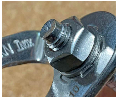
写真 30 : 締め込んでネジ山が 2 ～ 3 山出てきている状態が適切
