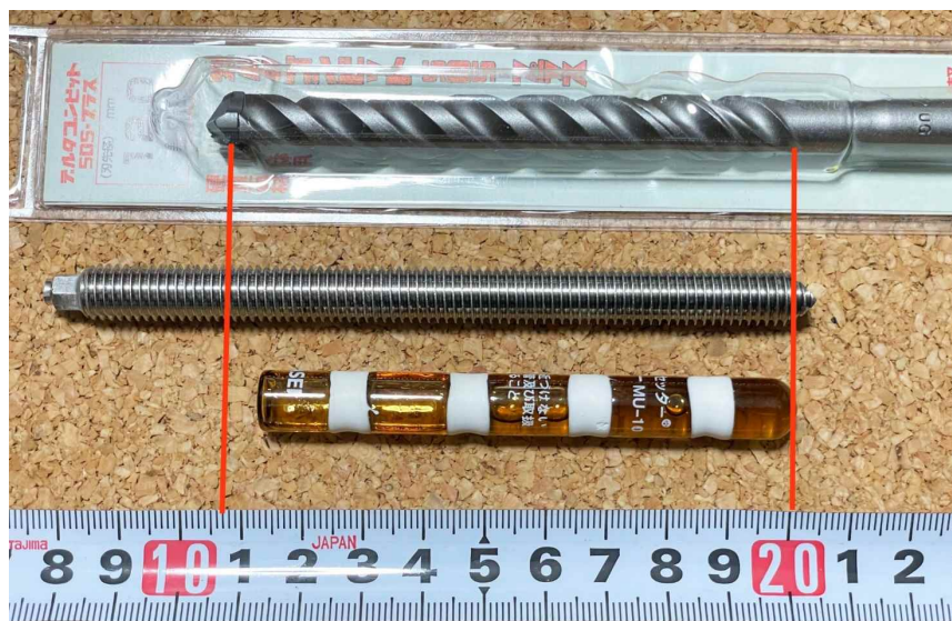
写真 2 3 : 10mm 径、全長 120mm の全ネジボルトをアンプル施工する場合
