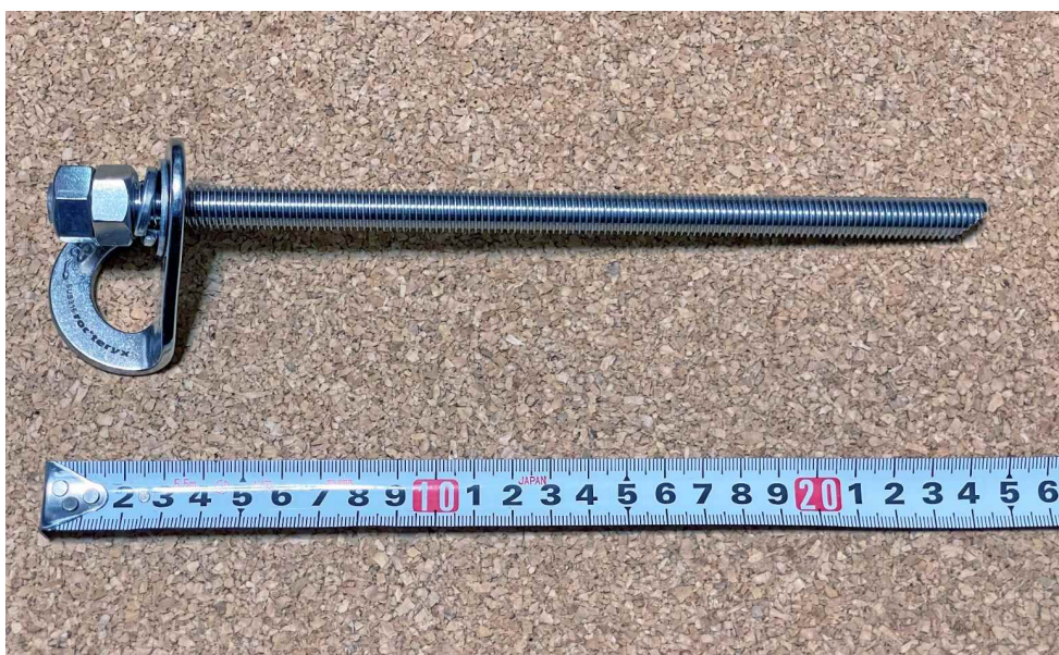
写真3：ハンガー、平ワッシャー、スプリングワッシャー、ナットを取り付けたボルト
