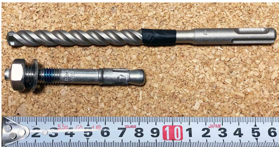
写真 29：ハイテンションアンカーの穿孔は必ずボルトと同径のドリルビットで行なう
