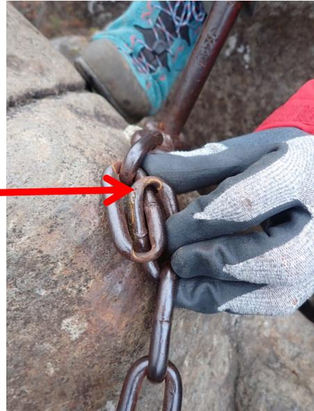
写真3：連結部分が摩耗しているクサリ
