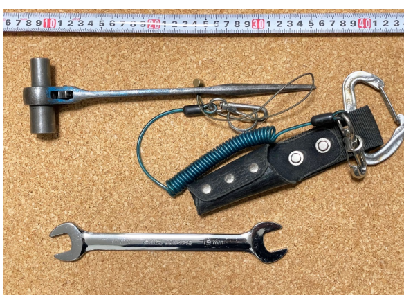
写真6：13/17mmのコンビネーションラチェットスパナ（上）と17/19mmのコンビネーションスパナ（下）
