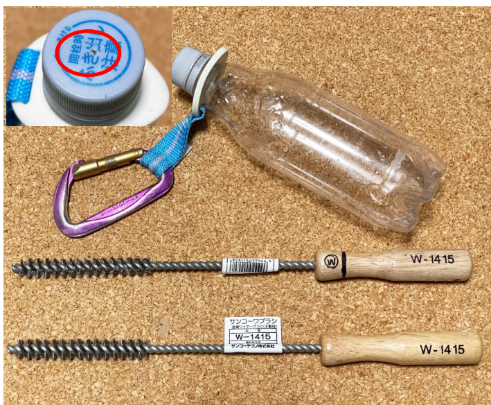
写真5：洗浄水を入れるペットボトルとアンカーホールブラシ。アンカーホールブラシには同じホルダーでブラシ部分のみサイズ交換して使えるタイプもある(HILTI製)。また水洗い用のブラシにはサインペンやビニールテープなどで湿式・乾式がひと目でわかるように目印を付けておくとよい。
