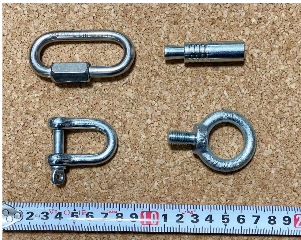
写真7：シャックル（左下）とアイボルト（右下）
