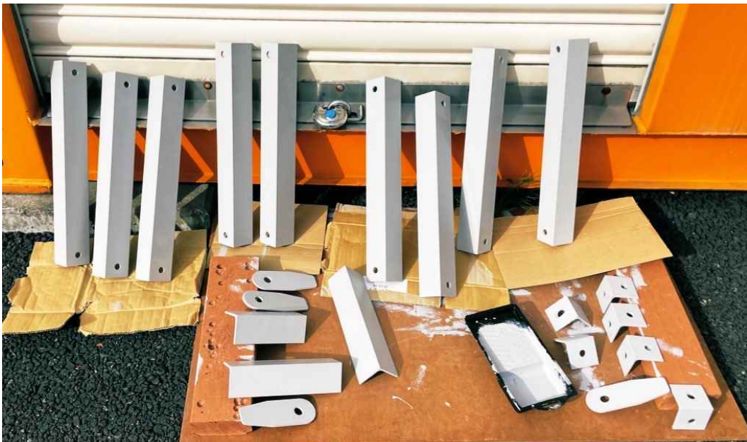
写真12：ハシゴのステップ用にカット、穴あけ、防錆塗装をしたアングル材。
