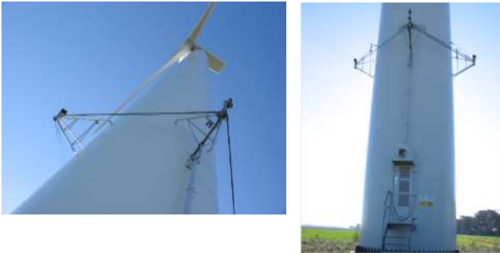
図 5- 26 WT-BIRD の騒音センサ部分
