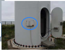
設置場所→センサー:ブレード内側 ロガー:風車基礎下部
