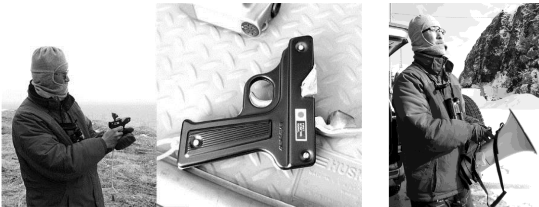
図 3-1- 16 音を鳴らすのに使ったスターターピストルと鳴き声再生に使用したスピーカー
