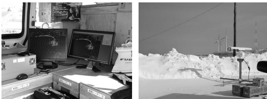
図 3-1- 5 レーダ記録部(左)と設置場所と対象風車
