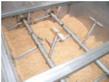
杉チップ 攪拌槽内部
