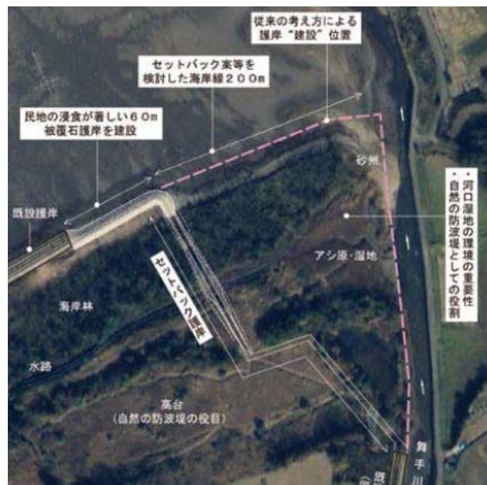
写真：中津干潟のセットバック護岸（「いきものにぎわいづくり」（国交省 2012 年）より）
