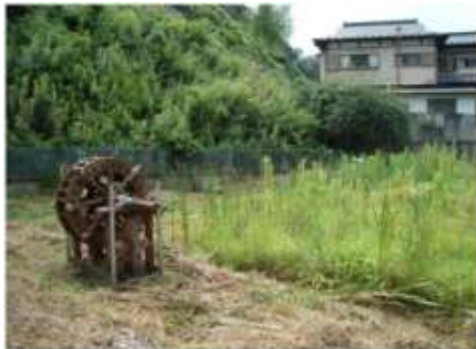
写真2 間伐材ヒノキ利用による水車(直径1メートル) 平成22年6月峠地区生き物の里に設置
