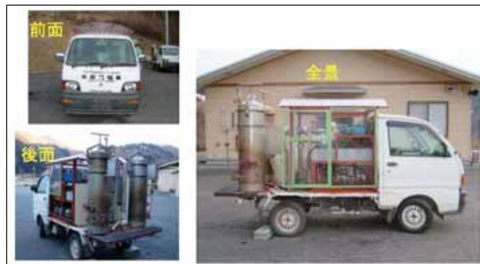
図 循環型システム実証事業 (上：事業概要 下：木炭発電車) (出典：生出地区コミュニティ推進協議会資料)
