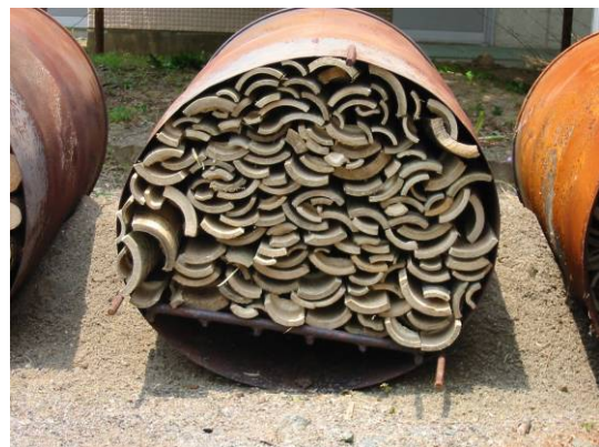
炭窯完成前の手づくりドラム缶炭窯
