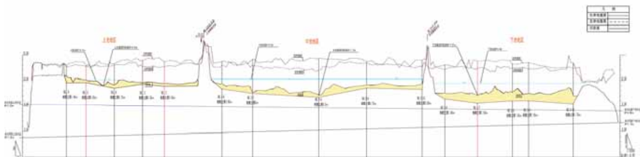
図2-14 旧流路堆積物堆積状況（H15調査）
