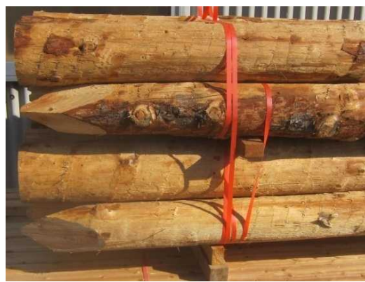
円柱加工を行っていない杭の例
