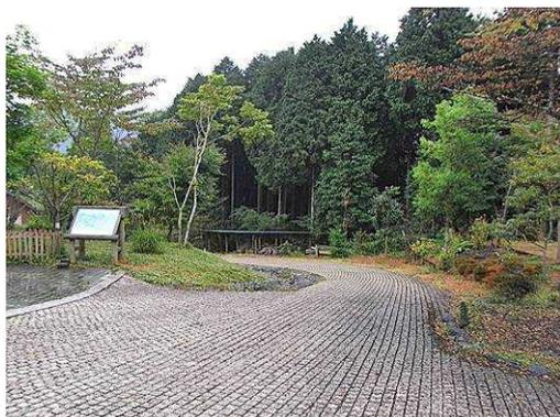
車いすでの通行には振動が激しく、苦痛を伴う小舗石舗装のスロープ
