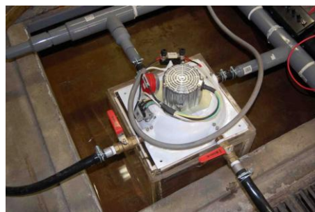
図 6-8.神奈川工科大学森研究室のミニ水力発電装置の試験の様子
