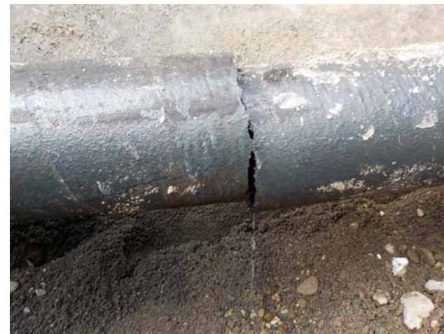
破断部分の拡大
