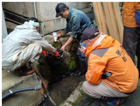
写真2 温度・湧出量計測の様子
