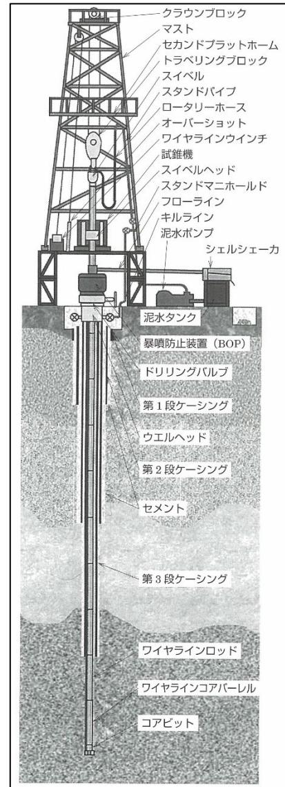
付図9 スピンドル式掘削の模式図
