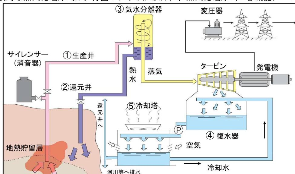
付図1 一般的な蒸気発電方式
