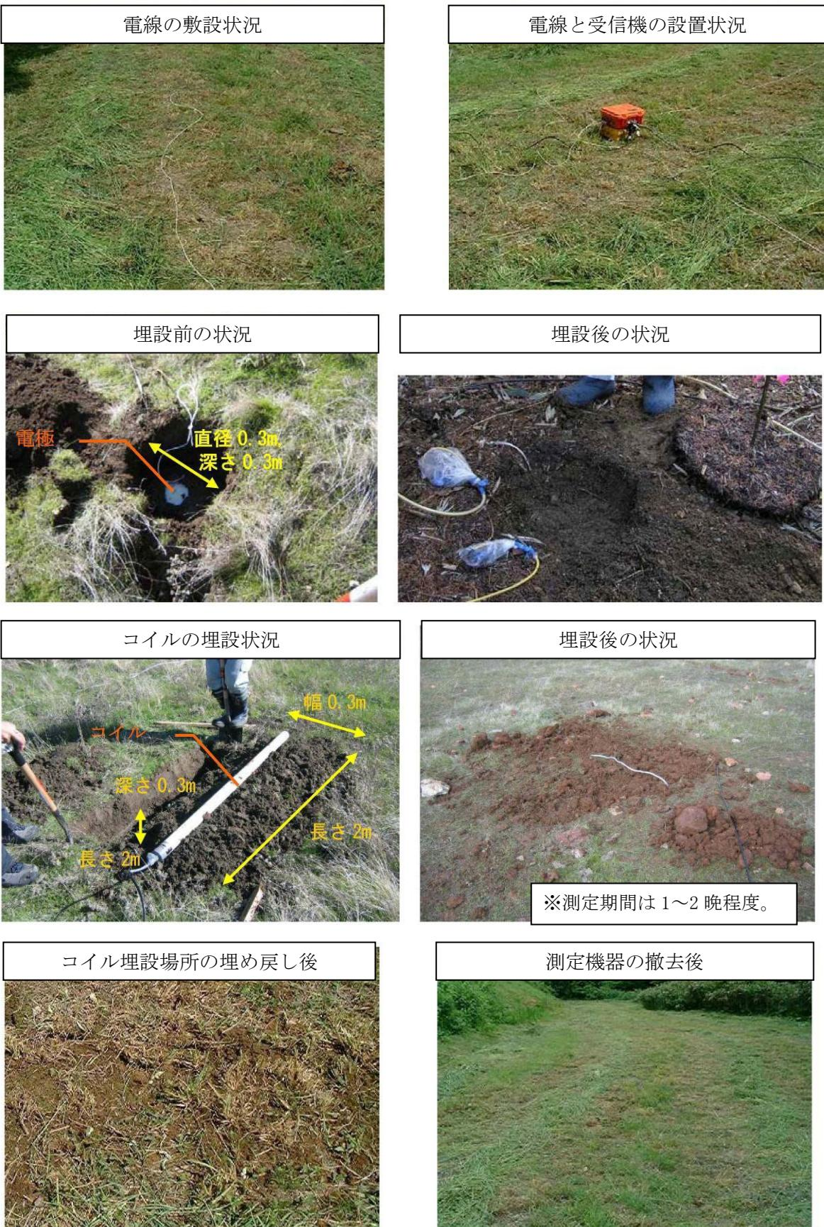
付図5 M T法電磁探査の調査状況例
