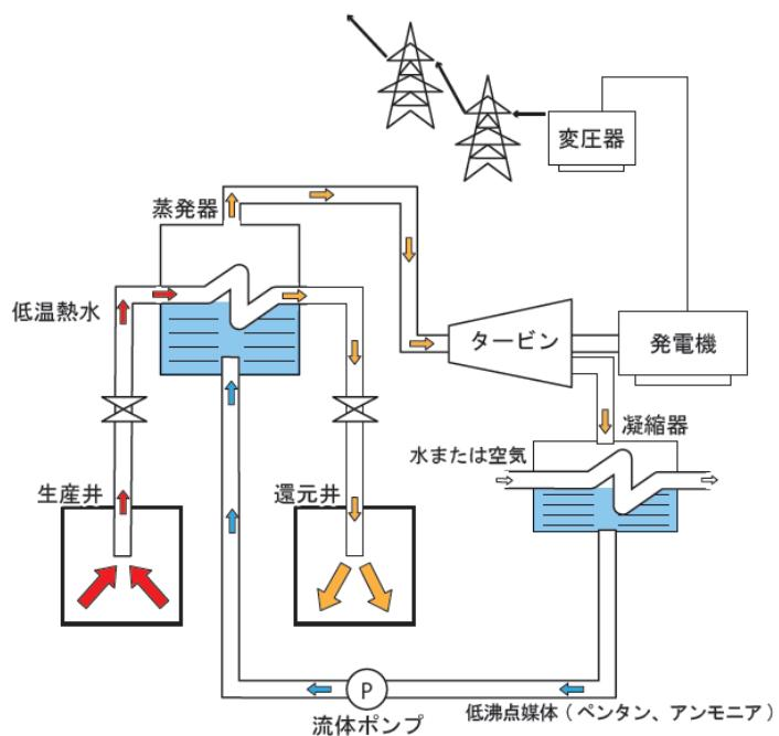
図3 バイナリー発電の仕組み
