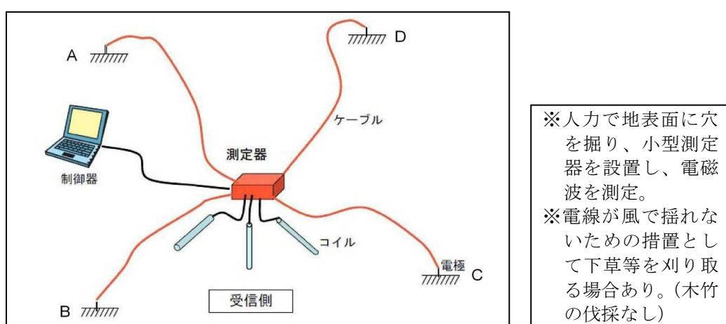
付図4 MT法電磁探査の機器設置イメージ
