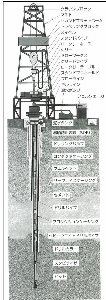
付図 10 ロータリー式掘削の模式図
