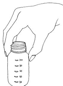
温泉付随ガスを湧出している温泉水中でポリビン静かに転倒し開口部を温泉付随ガスの湧出する下方に向ける。
