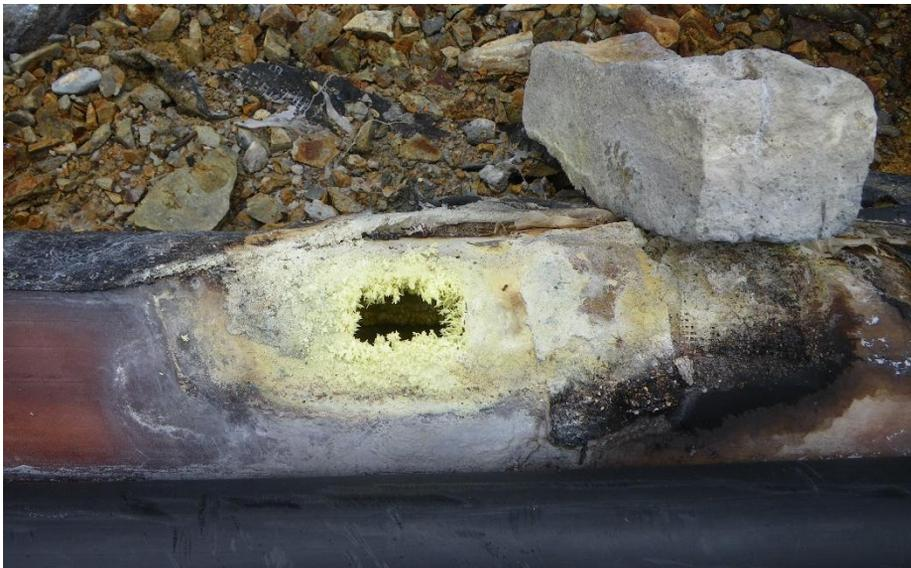
温泉配管にあけられた空気抜き穴に形成された硫黄の結晶(上の写真とは別の温泉)
