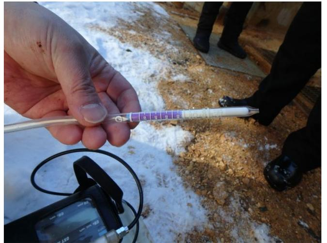
左写真貯湯槽内部のガス測定
