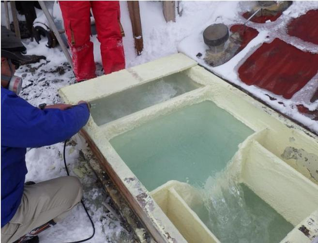
貯湯槽底部のガス測定
