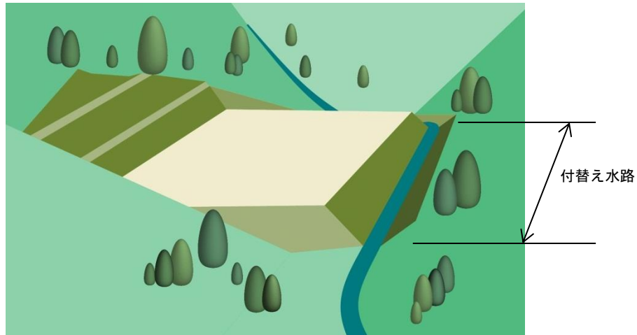
図 5.54 一般的な谷地造成付替え水路
