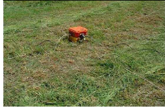
電線と受信機の設置状況
