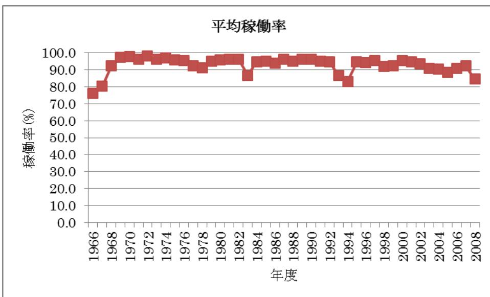
図 3-3 国内地熱発電所平均稼働率の推移
