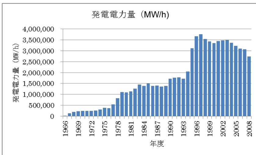
図 3-2 国内地熱発電所発電電力量の推移
