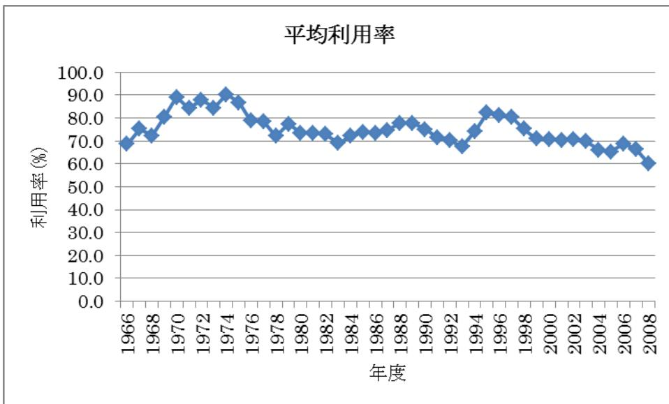
図 3-4 国内地熱発電所平均稼働率の推移
