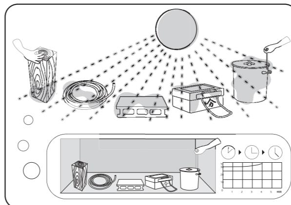
木、ゴム、コンクリート、発泡スチロール、金属など、さまざまな素材でできたものを用意します。直射日光下での表面温度の違いを、手で触って直接感じたり、温度計を使って計測します。直射日光で十分に暖まった素材を日陰に入れ、時間の経過と温度の変化(蓄熱の様子)を計測し、データをグラフにしてみましょう。
