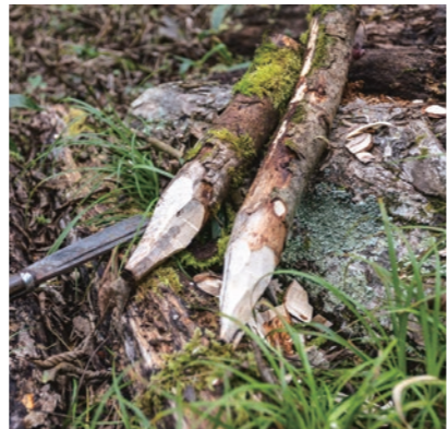
あらかじめ乾燥させておいた木の先端を、ナタで削って尖らせることで杭をつくる。
