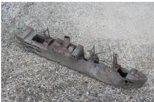
沈没船の実測データから3Dプリンタで作成された模型
