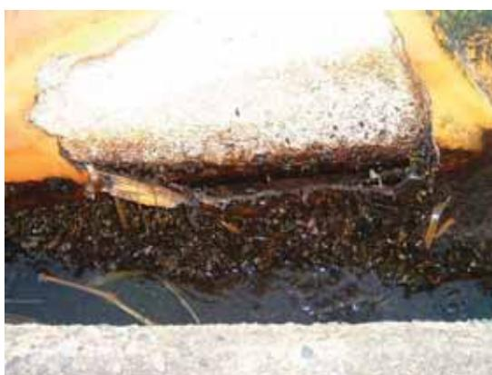
図 1-21. 黒部川に浮かべているオイルフェンス（持ち上げると水面下部分にカワヒバリガイがびっしり付着している。）
