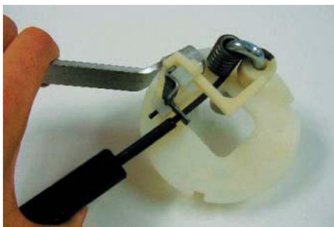
セッティング・ツールを使用して動作部をセットします。新品では部品が硬いため、セットに力を要しますが、慣れるとスムーズにセットできます。
