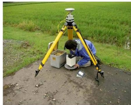
図 8 重力探査測定状況
