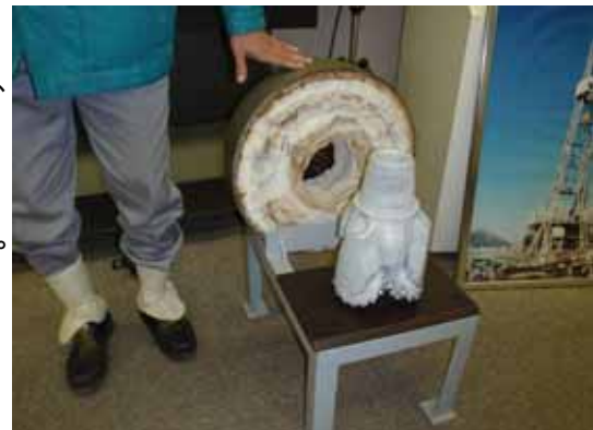
蒸気井内に付着したスケール
