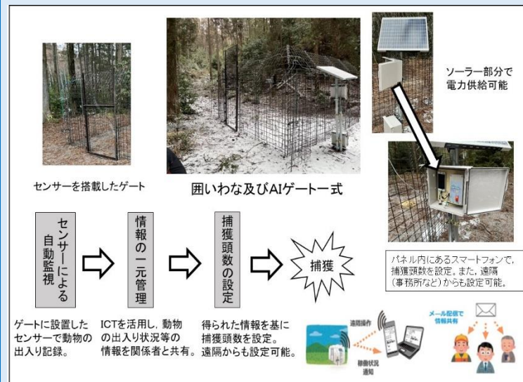
図2 組み立て式囲いわな及びAIゲート一式と捕獲に係るフロー図
