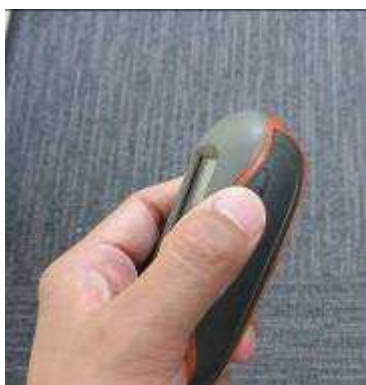
GPS の起動（電源長押し）
