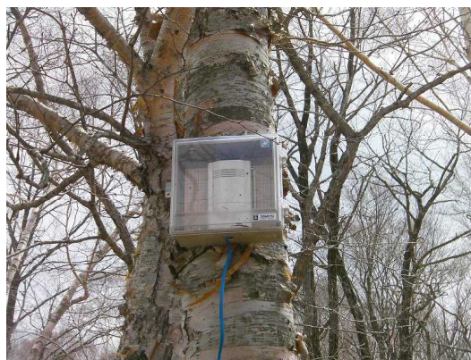
中継器 (防水ケースに収納)
