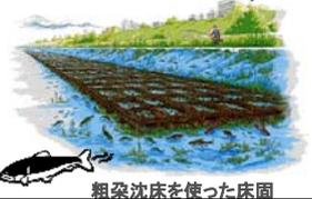
粗朶沈床を使った床固
