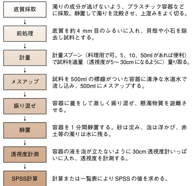
図2 SPSS (content of Suspended Particles in Sea Sediment = 底質中懸濁物質含量) 簡易測定法。サンゴ礁海域の底質は大部分がサンゴの骨格等の生物由来でできた砂で、流出してきた土壌粒子と粒径が異なる。これを利用し、底質1 m<sup>2</sup>あたりに懸濁物質（赤土等）として何 kg 含まれているかを求める
