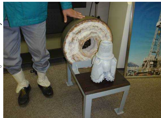
蒸気井内に付着したスケール
