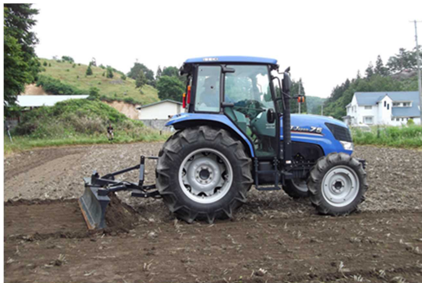
図 2-54 農機による農地の削り取りの例
