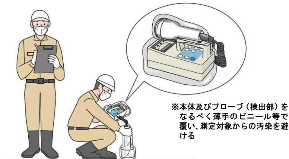
図 1-13 測定機器の使用方法（GM サーベイメータ）
