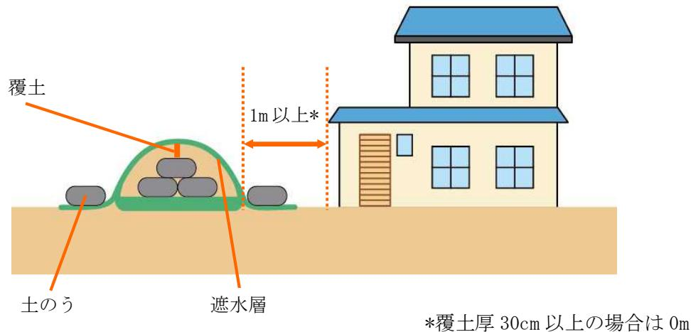
**図4-4 空間線量率が1マイクロシーベルト毎時程度の地域の除染で発生した除去土壤(2×2×1m)の保管例**
