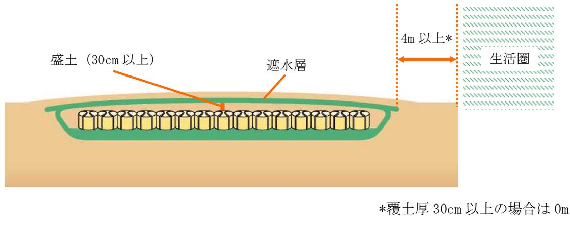
**図4-8 空間線量率が1マイクロシーベルト毎時程度の地域の除染で発生した除去土壤(20×20×1m)の保管例**
