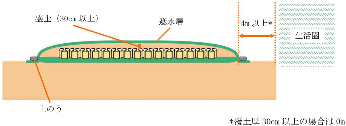
**図4-7 空間線量率が1マイクロシーベルト毎時程度の地域の除染で発生した除去土壤(20×20×1m)の保管例**
