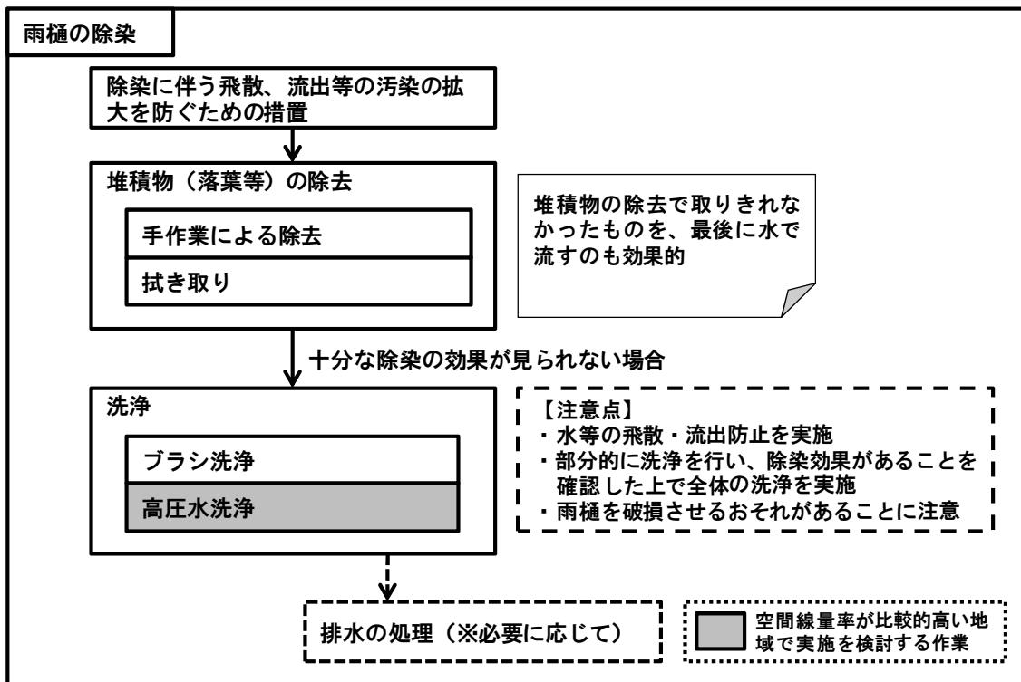
図 2-11 雨樋の除染の基本的な流れ
