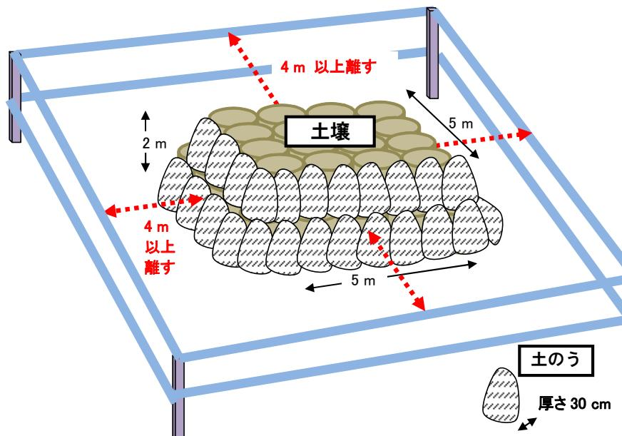
2 万 Bq/kg の除去土壤（縦、横、高さが 5m×5m×2m）に対して側面を土のう（30 cm）で遮へいした場合
