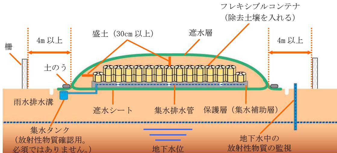
**図4-11 空間線量率が1マイクロシーベルト毎時程度の地域の除染で発生した除去土壤(100×100×2m)の保管例**
