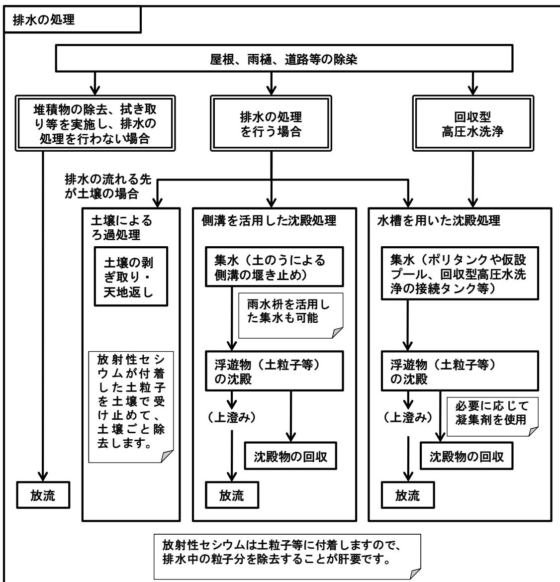
図 2-29 排水の処理の基本的な流れ
