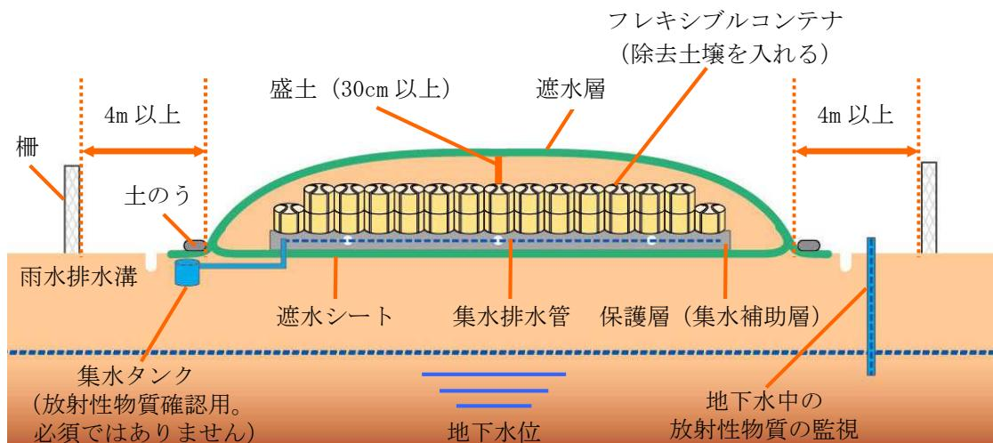
**図4-10 空間線量率が1マイクロシーベルト毎時程度の地域の除染で発生した除去土壤(20×20×2m)の保管例**
