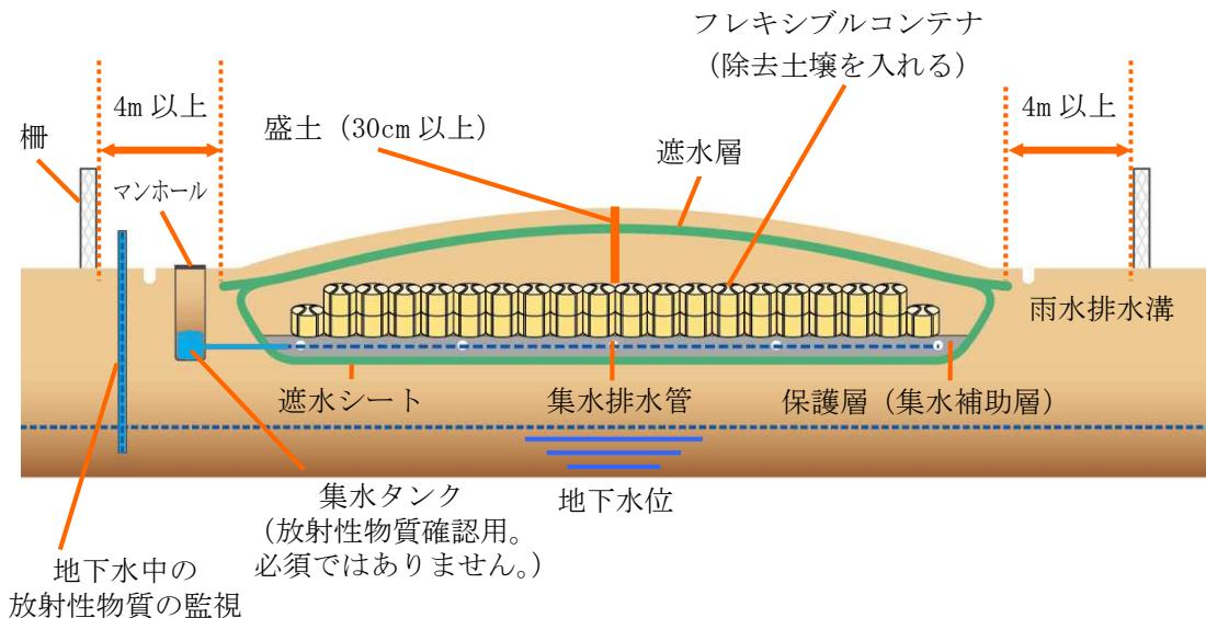
**図4-12 空間線量率が1マイクロシーベルト毎時程度の地域の除染で発生した除去土壤（50×50×2m）の保管例**
