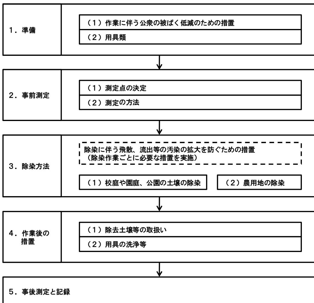
図 2-43 土壤の除染等の措置の基本的な流れ
