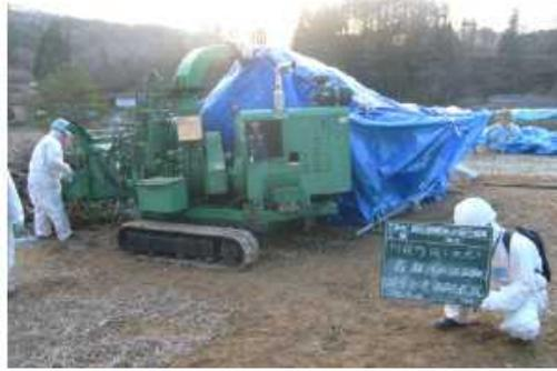
図 2-20 破碎機（チップパー）による減容化（例）
