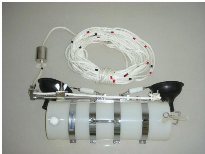
図. 7 バンドーン型採水器
