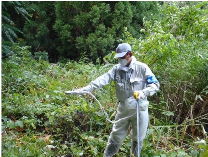
図.6 空間線量率の測定（例）
