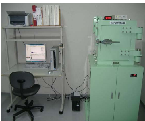
参考写真1-1 ゲルマニウム半導体検出器
