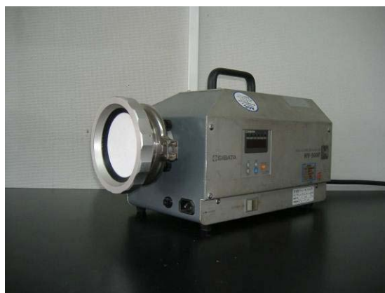
参考写真4-2 ハイポリウムエアサンプラー
