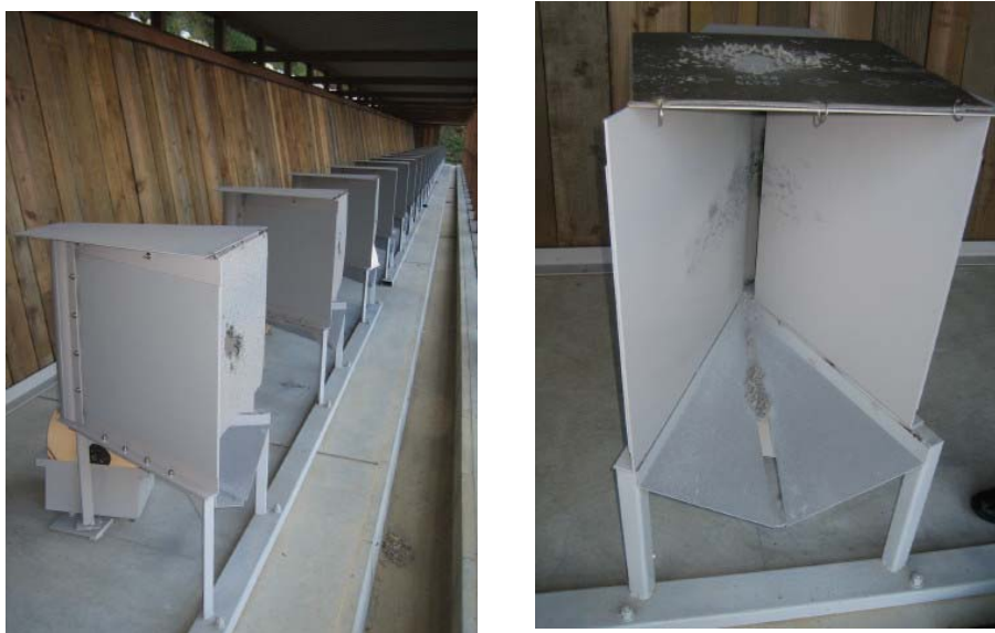
図5-10 ライフル射撃場における鉛弾回収装置の例
