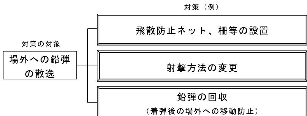
図 3 - 4 鉛汚染問題の解消を対策目的とした場合の対策の例③ （場外への鉛弾の散逸を対策の対象とした場合）
