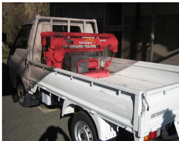
図5-16 網を持ち上げるクレーンの例
