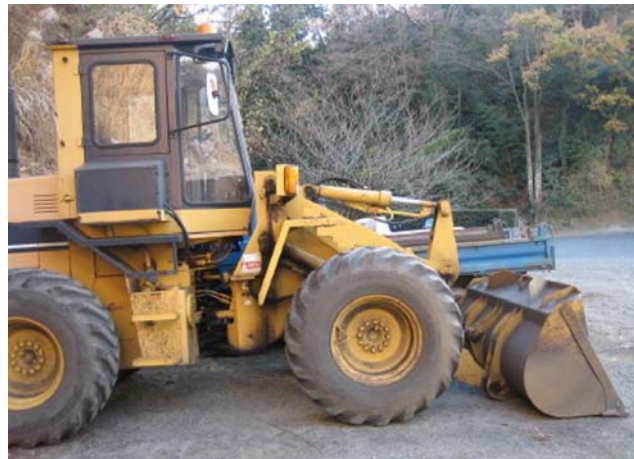
鉛弾等回収に用いる重機の例 （舗装されている射撃場におけるタイヤ走行型重機の例）
