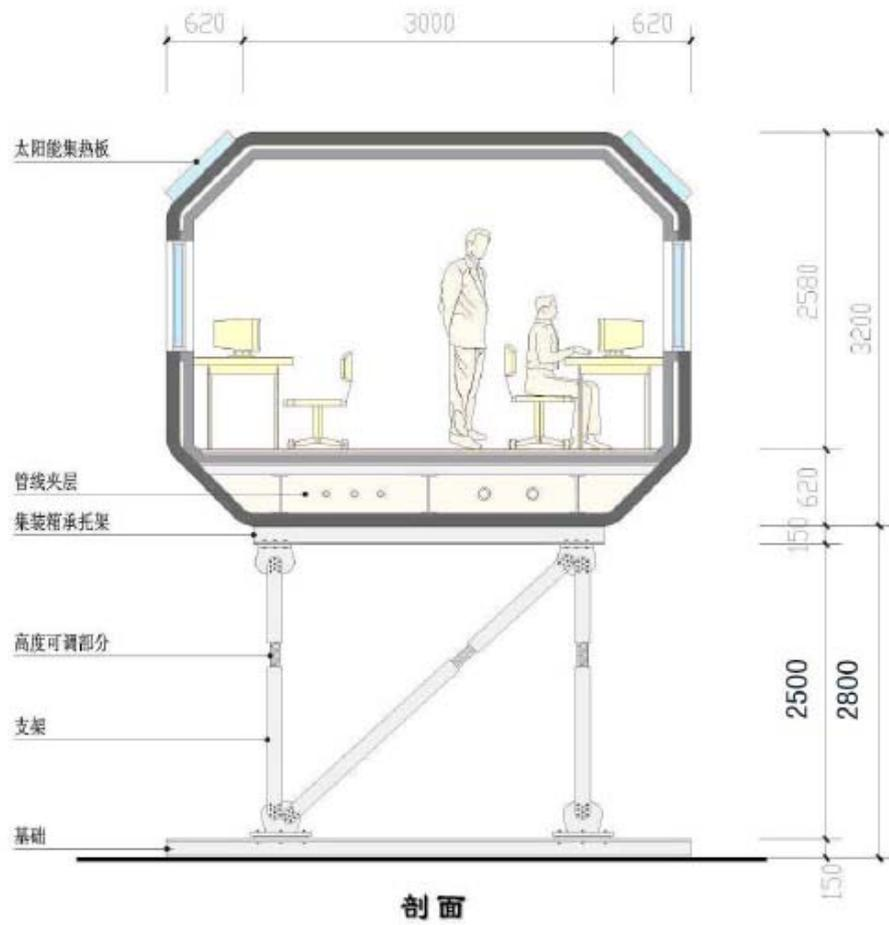
图7 变形集装箱的断面图
