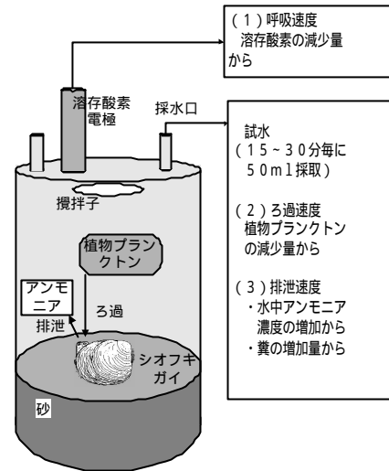
図5 二枚貝の呼吸・ろ過・排泄速度測定装置概略図
