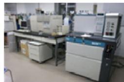
ガスクロマトグラフ 燃焼質量分析計 (GC/CIRMS) 元素分析計オンライン 質量分析計 (EA/IRMS)
